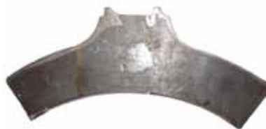
Рис. 8. Инновационный рабочий инструмент с выделенной рабочей частью
