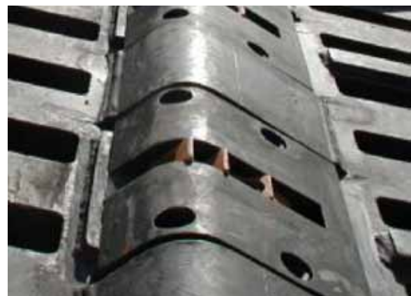
Рис. 5. Выдвижные ножи Acti-Plate (Fuji King)
