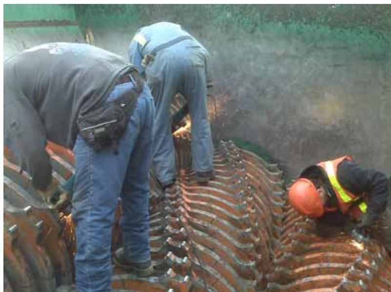
Рис. 9. Восстановление рабочей части оборудования после обработки 600 тыс. м 3 древесины
