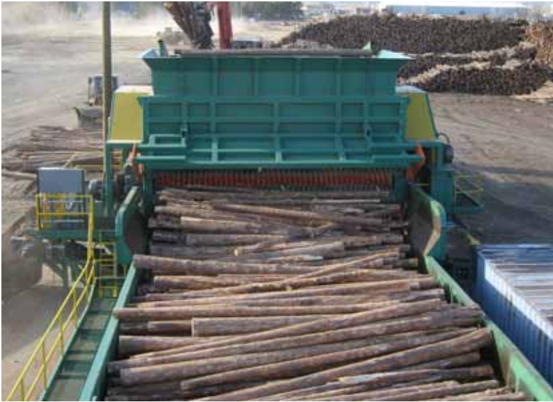
Рис. 10. Загрузка погрузчиком и разгрузка на поперечный транспортер
