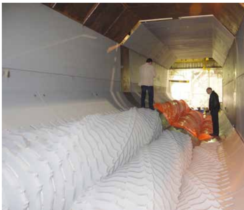
Рис. 7. Окорочный станок Deal
