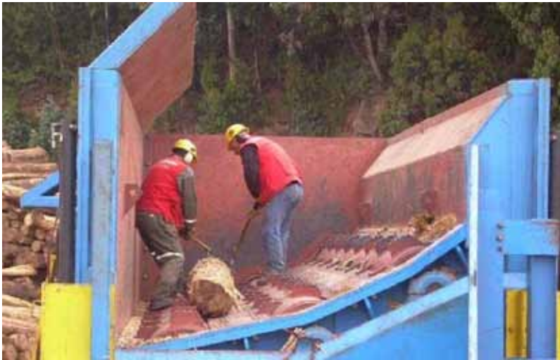
Рис. 3. Опорожнение роторного окорочного станка с «закрытым дном»
