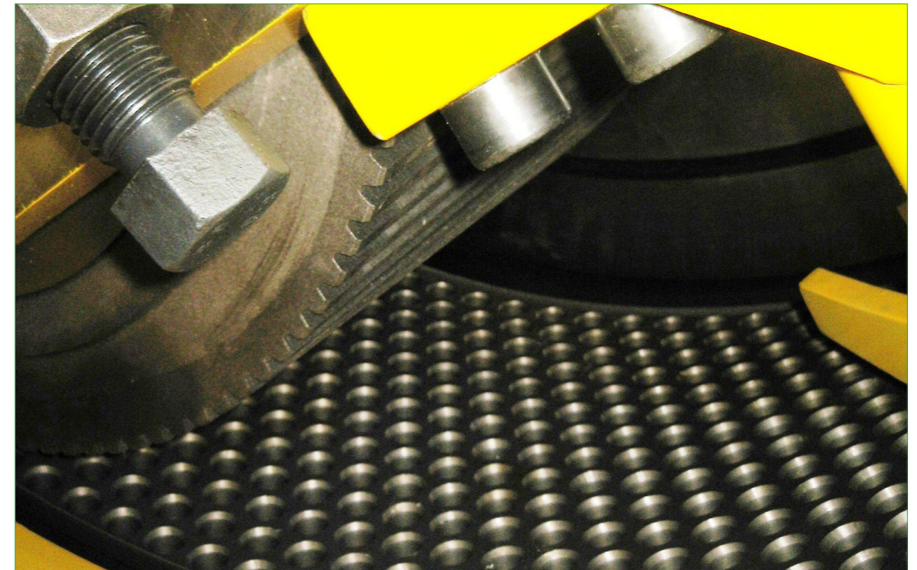
Рис. 2. Пример рельефа рабочей поверхности матрицы и роликов
