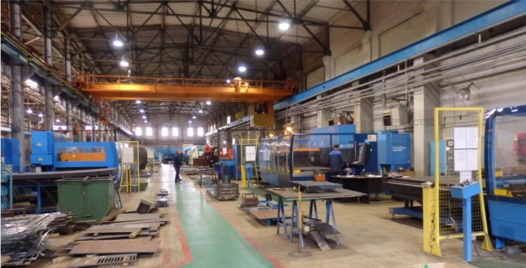
Цех раскроя листового металла (лазерные и вырубные станки с ЧПУ).
