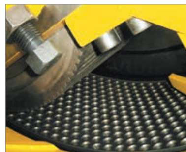
Рис. 1. Пример рельефа рабочей поверхности матрицы и роликов
